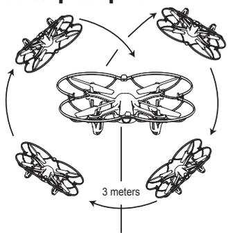
Когда вы освоили азы пилотирования, вы можете попробовать пару захватывающих трюков. Сперва, взлетите на высоту более 3-х метров, нажмите кнопку флипа на тыльной стороне передатчика, затем потяните правый стик в любом направлении для переворота на 360 градусов.
