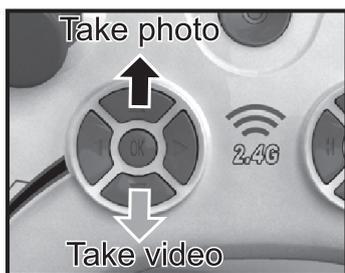
**Сделать фото:** убедитесь, что камера функционирует исправно. Нажмите верхнюю кнопку «С» – камера сделает фотоснимок после звукового сигнала передатчика, индикатор камеры в этот момент на долю секунды изменит цвет на красный.
