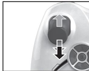
Шаг 3: переместите ручку газа в максимальное положение (до верхнего упора), затем опустите её в минимальное положение (до нижнего упора). Вы услышите звуковой сигнал, который оповещает о том, что двигатели и управление активированы.
