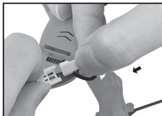
Шаг 2: соблюдая полярность, подключите разъём аккумулятора к разъёму квадрокоптера. Установите модель на ровную поверхность.
