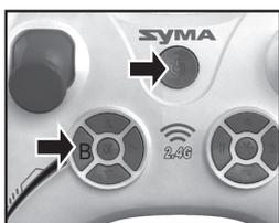
Быстрый сброс триммеров: при выключенном передатчике нажмите и удерживайте кнопку В, не отпуская кнопку включите передатчик, отпустите кнопку.
