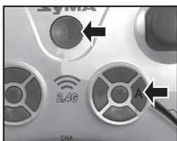
Переключение раскладки (Mode 1 или Mode 2): при выключенном передатчике нажмите и удерживайте кнопку А, не отпуская кнопку включите передатчик, отпустите кнопку.
