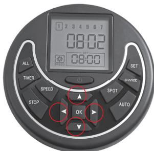
Во время уборки или поиска станции зарядки можно в ручном режиме направлять робот-пылесос используя кнопки
