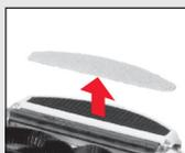
Накладку на моющую панель следует промыть горячей водой и просушить.
