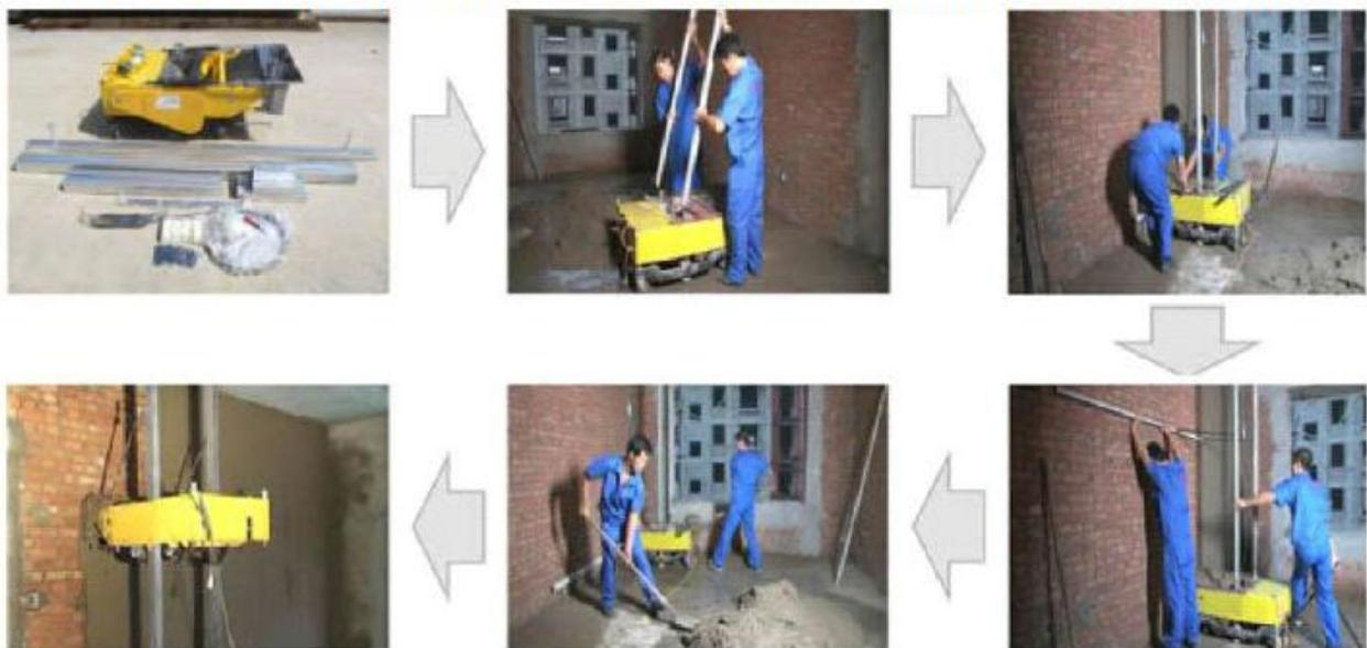
Штукатурная машина поставляется в комплектации полностью готовой к работе. Перед началом работы необходимо проверить надежность креплений узлов оборудования и при необходимости подтянуть их. Произведите сборку, выполнив последовательно следующие действия: Установите штукатурную машину на горизонтальную плоскость и произведите подключение питающего провода к электрической сети. Вытащите проволочный трос двумя руками вертикально, здесь возможно два положения:
